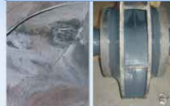
Juoksupyörä ja pesä ennen korjausta. Juoksupyörässä vakavia kulumis- ja kavitaatiovaurioita
